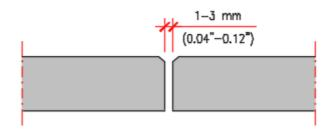
Figure 3.15 - Bevelled edge
